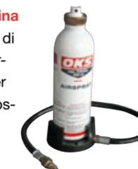
Ecco come funziona: riempire la bomboletta Airspray di prodotto, introdurre il tubo montante con adattatore, applicare la valvola con ugello sull'adattatore e avvitare a mano il dado di raccordo. Mettere la bomboletta con la valvola sulla stazione di rifornimento e premere per circa 2 s. Ora è pronta per spruzzare.
