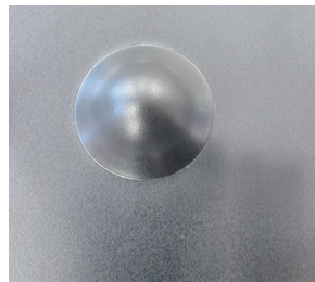
Erichsentiefung mit 8mm nach DIN EN ISO 1520
