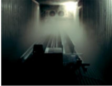
igus® Klimakammer - E-Ketten® und Chainflex®-Versuchsreihen bei -40°C bis +60°C möglich
