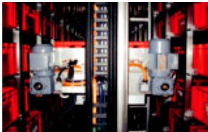
Werkzeugmagazin - igus® E2/000 E-Kette® konfektioniert
