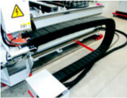
Vorkonfektioniertes E-Rohr für das Bearbeitungszentrum.
