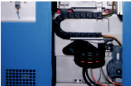
Horizontal Bearbeitungszentrum - Konfektioniert mit dem igus®
