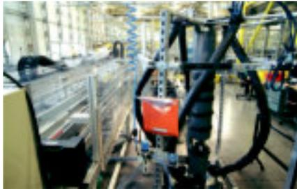
Komponententest - Kabelprüfungen auf Torsion
