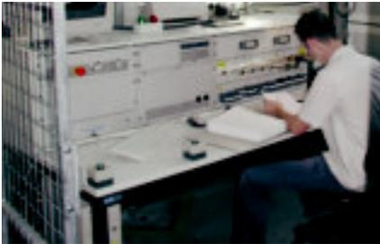
Rechnergestützte Hochspannungsprüfplätze sorgen bei igus® für geprüfte Qualität
