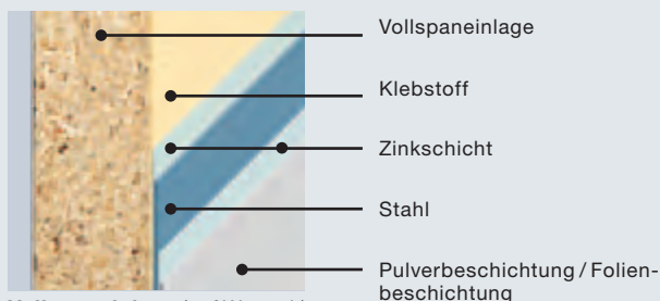
Vollspaneinlage (auf Wunsch) für verbesserten Schallschutz
