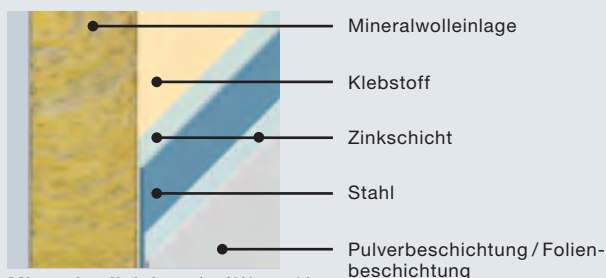
Mineralwolleinlage (auf Wunsch) für bessere Wärmedämmung
