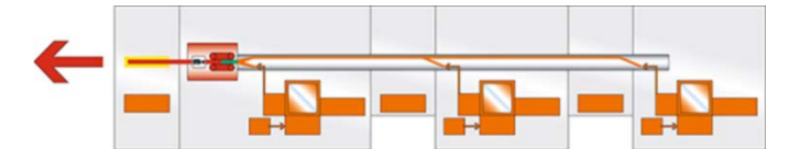
Zwei bodennahe Kaskaden-Sortierwerke
