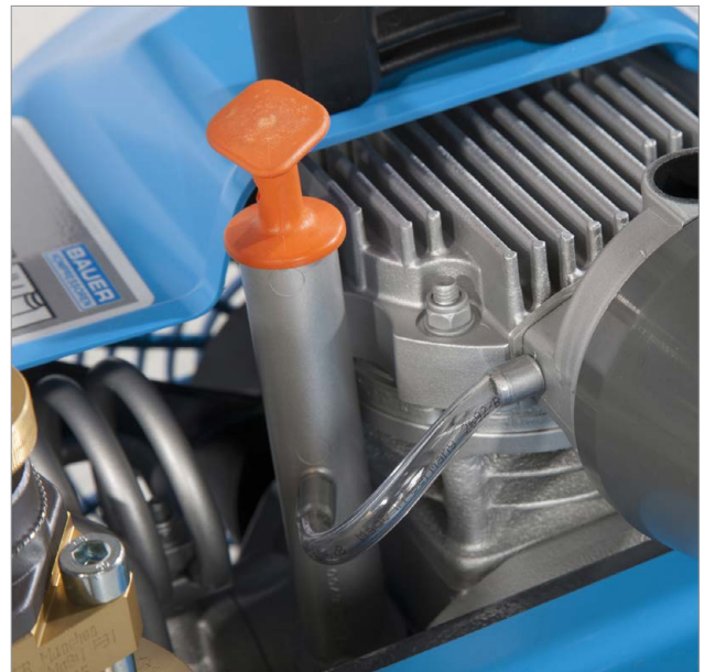
Öleinfüllstutzen mit Ölpeilstab
