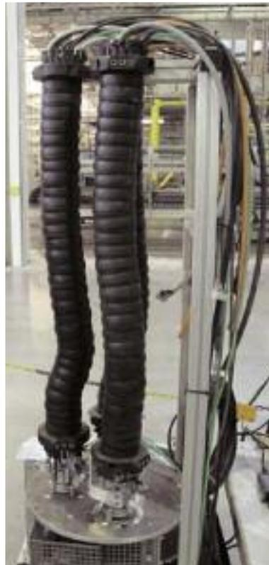
Nach dieser Norm werden alle Chainflex® ROBOT-Leitungen einer Triflex® R-Energieführung mit einem Festpunktabstand von einem Meter und einer Torsion von  $\pm 180^\circ$  mindestens 3 Millionen Mal tordiert.
