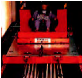
Crashtestanlage: Geschwindigkeit 22 m/s und Beschleunigung 784 m/s 2 ► Seite 1.19
