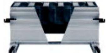
Abbildungen: Führungsrinne mit Gleitschienen. Wir empfehlen die Verwendung von Kunststoffgleitschienen von igus® aus igulen. Sie sind optimal auf das Material der E-Ketten® abgestimmt und erreichen die niedrigsten Werte hinsichtlich Reibung, Geräuschentwicklung und Verschleiß.
