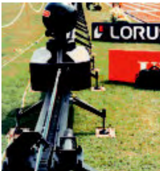
Fahrbarer Kamerawagen, olympische Spiele Atlanta, S = 100 m, v = 10 m/s im Zugbetrieb
