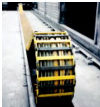
Serie 38 im Betonwerk mit Staub und teilweise Betonschlamm
