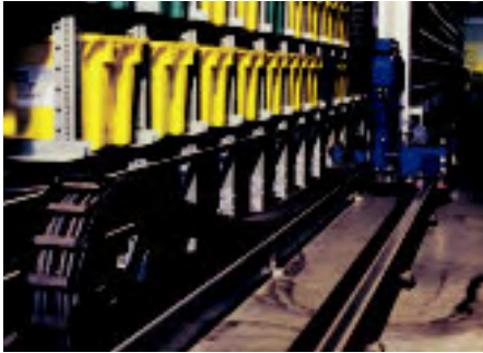
Regalbediengerät mit Serie 350 und Chainflex®- Leitungen - Verfahrsweg bis 80 m und v = 4,5 m/s, E2 medium
