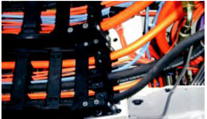
igus® Chainfix Zugentlastung im KMA in der Praxis - hier genutzt für Kabel und Schläuche
