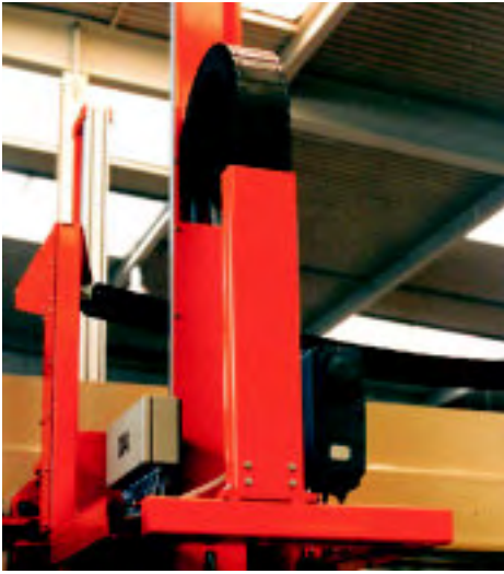
U-förmig unterstütztes Energierohr bei hoher Querbeschleunigung
