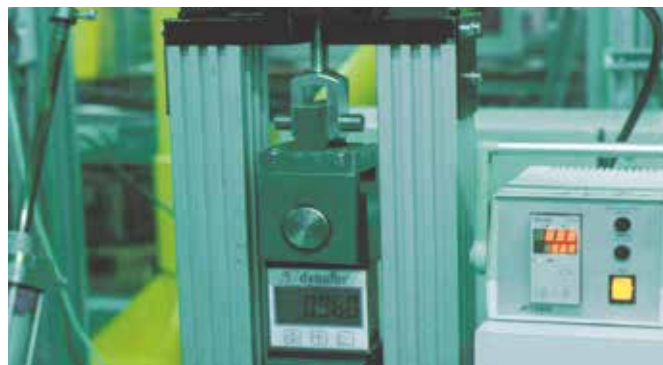
使用温度 250℃、面圧 150MPa で評価試験を実施中
