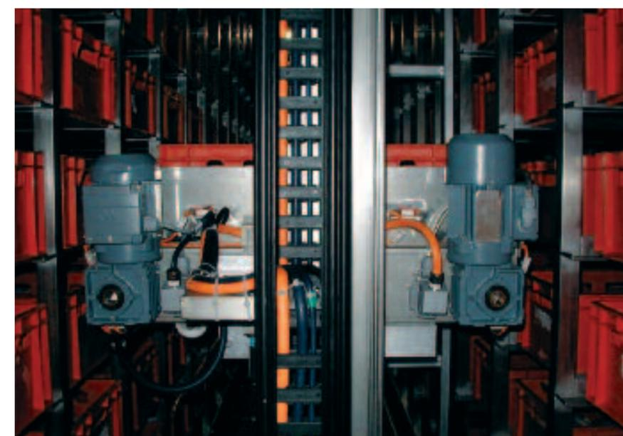
Steuerleitung chainflex® CF10 in Regalbediengeräten. e-kette®: System E2
