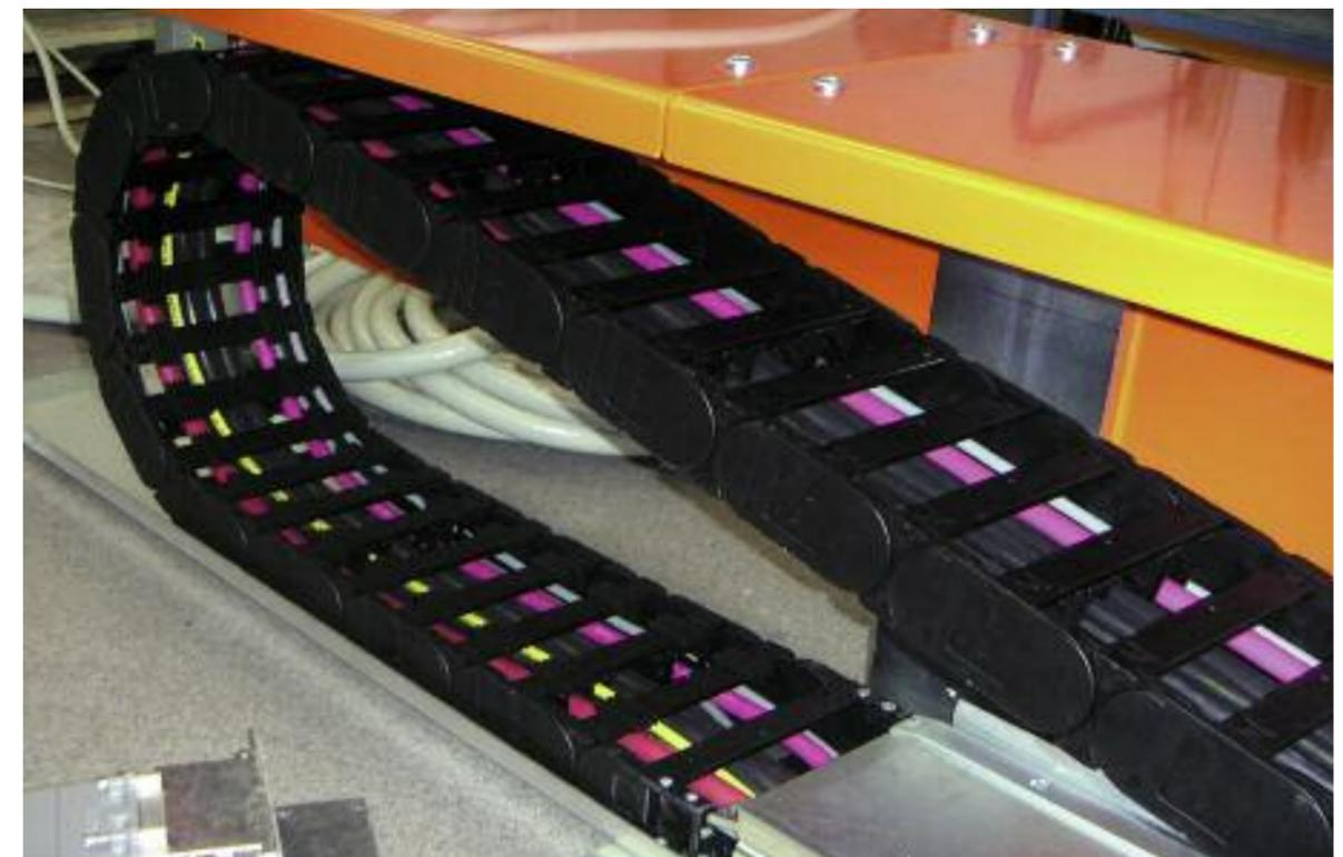
chainflex® CF2-Leitungen sind öl- und kühlmitelbeständig. e-kette®: System E4/00
