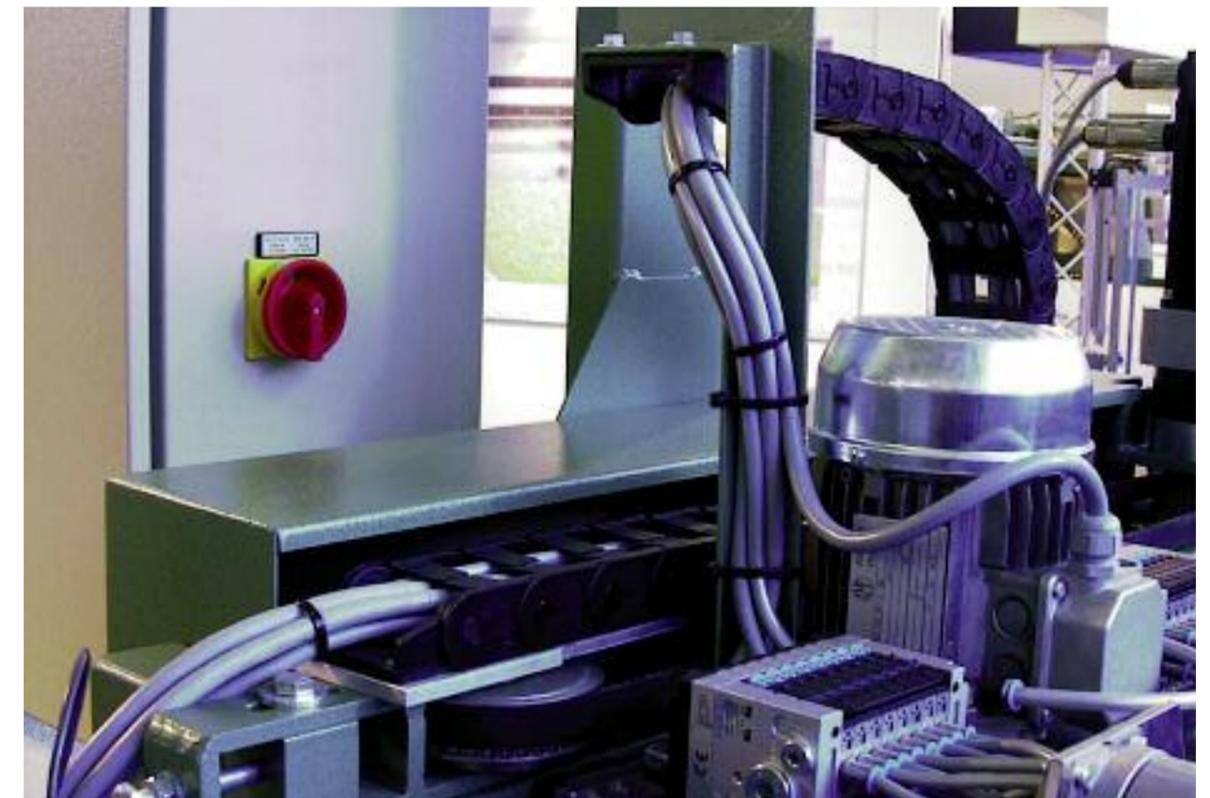
chainflex® CF140.UL in der Zuführungsautomation. e-kette®: easy chain®
