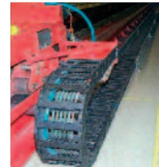
chainflex® CF5/CF6 in Regalbediengerät: langer Verfahrweg in Längsachse. e-kette®: Serie E4/00 mit igus® Führungsrinne aus Stahl
