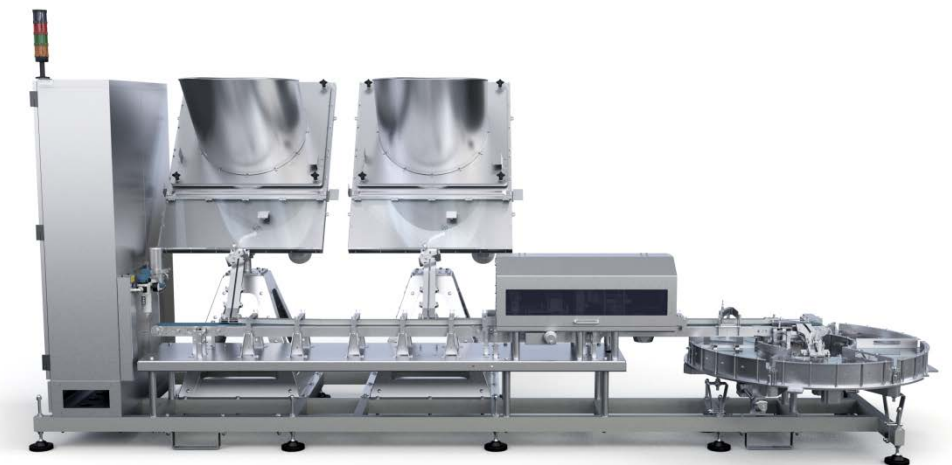
Mecanismo clasificador inclinado para dos tipos de tapones
