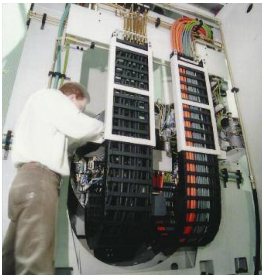
Modular aufgebaut und problemlos nachrüstbar: igus® E4-Energiezuführung und Chainflex®-Leitungen.
