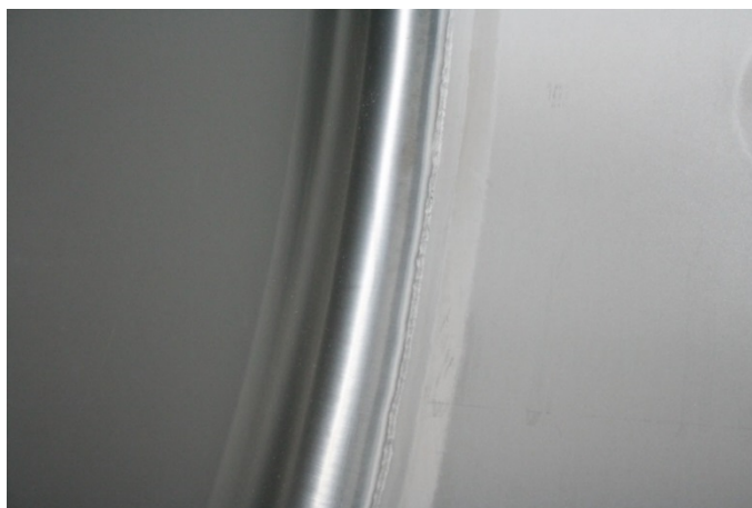
经酸洗处理，带轧制光泽， 焊缝凸起
