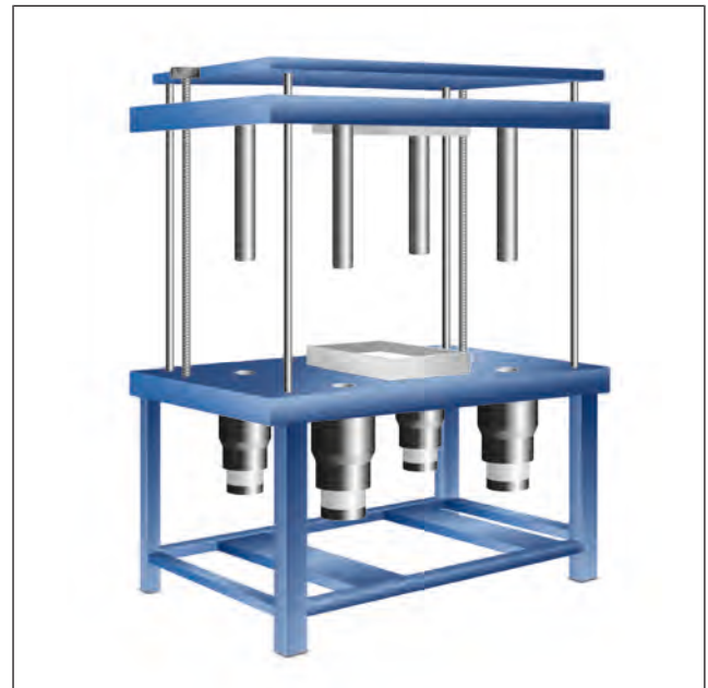
Abb. 2: Beispiel für ein- und ausfahrende Stangen mit 4 x PowerStroke FSK-SVE
