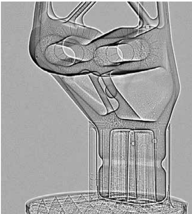
Röntgenbild eines Seitenspiegels mit optimierten Einstellungen für die manuelle 2D-Prüfung.
