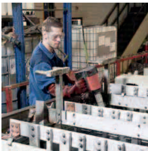
Entleerung eines Galvanikbeckens (F 424 PP).
