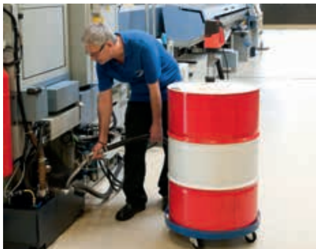
Befüllen einer Anlage mit Hydrauliköl (F 430 AL).
