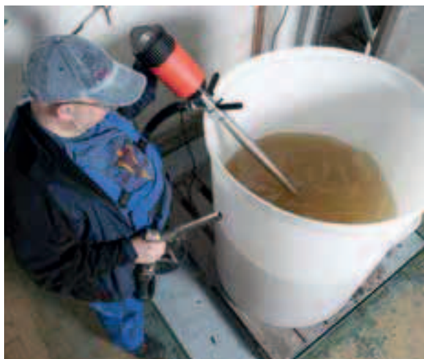
Mit der F 426 können inhomogene Medien vor dem Abfüllen kurz durchgemischt werden.
