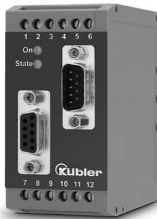
Der Frequenzteiler FT dient zur fehlerfreien Teilung von Frequenzen bzw. Impulsen herkömmlicher Drehgeber, Sensoren oder sonstiger Inkremental-Messsystemen. Über vier leicht zugängliche DIL-Schalter können wahlweise Teilungsverhältnisse von 1:1 bis 1:4096 sowie die gewünschte Darstellung der Drehrichtung programmiert werden. Für den Nullimpuls ist ein separat einstellbarer Teiler vorhanden.
