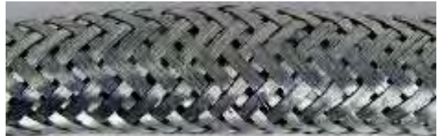
CF27.40.10.02.01.D: Nach über 10 Millionen Biegungen keine Schirmdrahtbrüche
