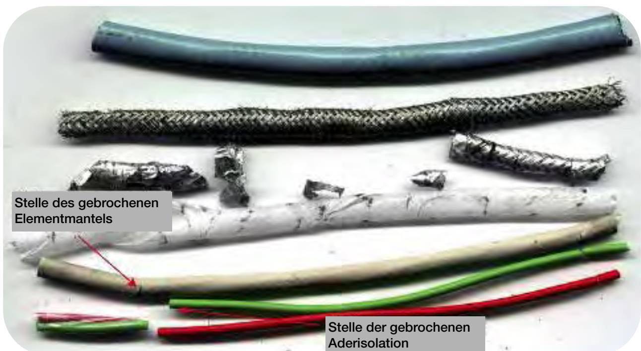
Bild 3: Ein mechanisch minderwertiger Elementmantel kann das Buspaar nicht vor der hohen mechanischen Belastung in der Energiekette schützen.
