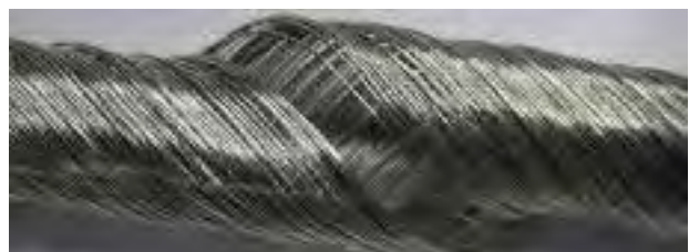
Bild 3: Detailbilder der CF ROBOT nach über 3.0 Mio Bewegungen von \pm 270^\circ
