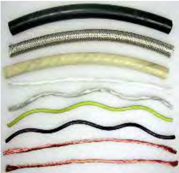
CF21.UL: Gesamtverseilung als auch Außenmantel ohne Beschädigung
