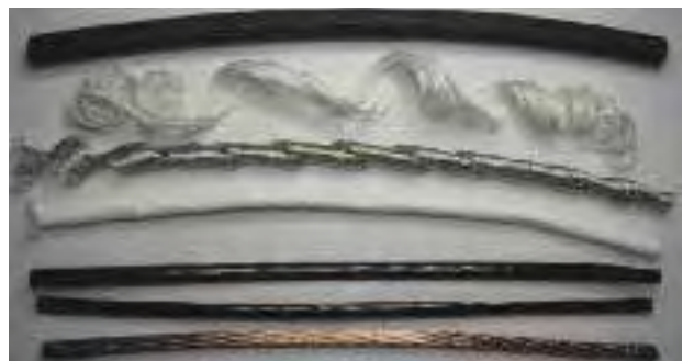
Bild 2: Die CF ROBOT zeigt keinerlei Beschädigung nach über 3 Mio. Bewegungen
