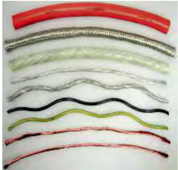
CF27.D: Gesamtverseilung als auch Außenmantel ohne Beschädigung
