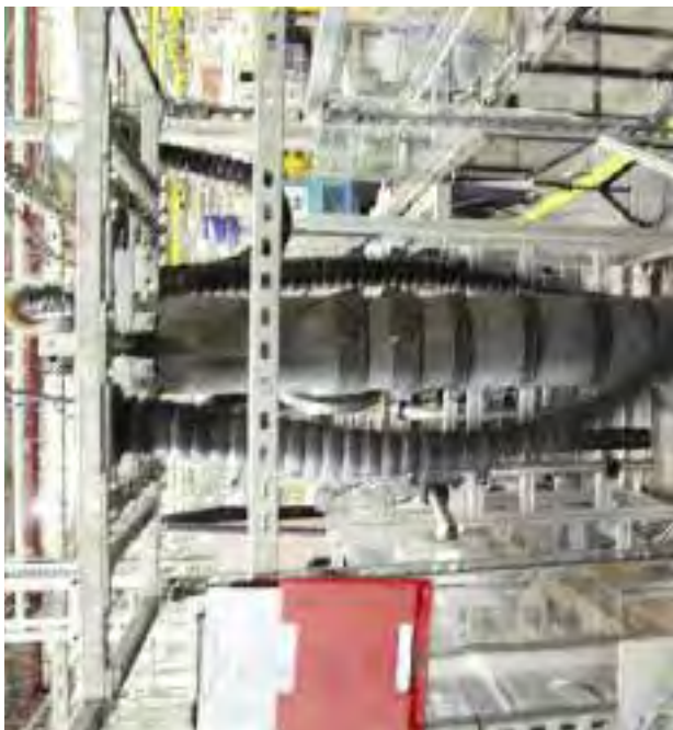
Bild 2: Die CF ROBOT zeigt keinerlei Beschädigung nach über 3 Mio. Bewegungen
