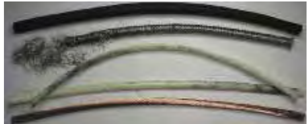
Bild 1: Beschädigter Gesamtschirm Muster der Geflechtversion nach 250.000 Bewegungen
