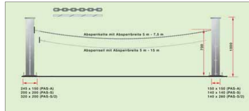
Absenker PAS mit Bodenplatte (mm)
