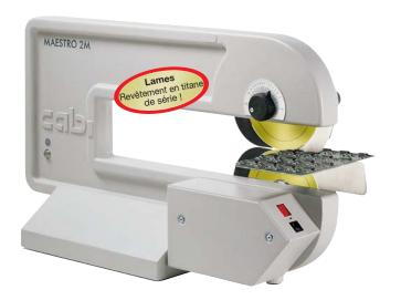
Le séparateur compact MAESTRO 2 sépare rapidement et économiquement les circuits imprimés. Il ne nécessite qu'une faible surface de travail.
