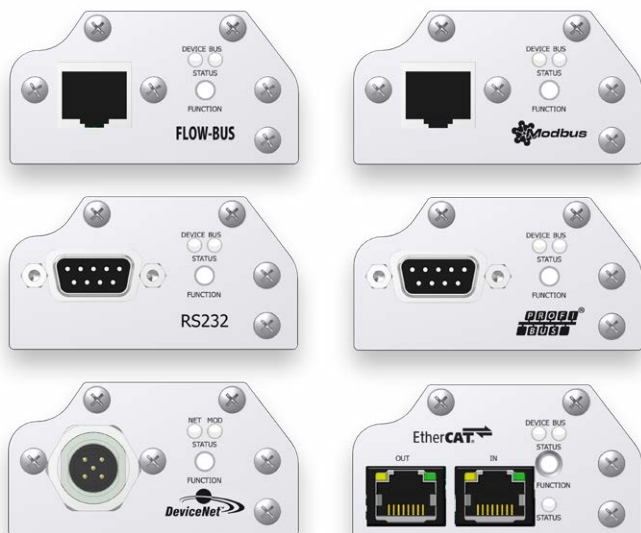
CEMシステム温度制御のためのフィールドバス構成例
