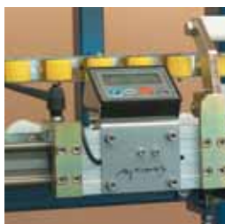
DryLin® W als Anschlagssystem in der Glasindustrie
