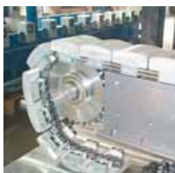
DryLin® W im Dauereinsatz in einer Förderkette
