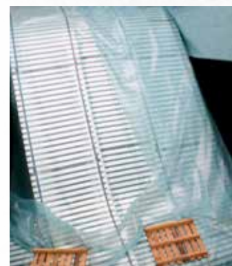
Détails: Tubes composites de 80x30x2 assemblés en 2 bandes
