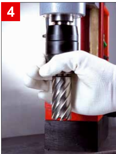
Bild 3: Der Kernbohrer steckt in der EasyLock. Die Maschine ist nun betriebsbereit.
