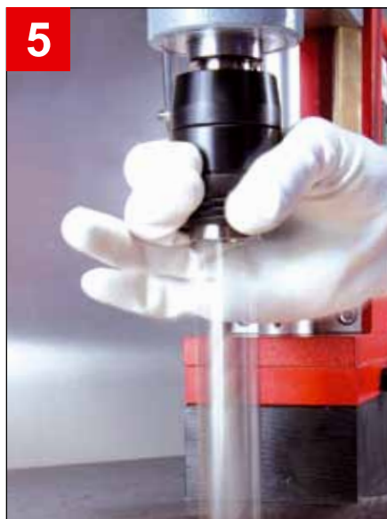
Bild 4: Um den Kernbohrer zu lösen, schieben Sie den Arretierungsring nach oben.
