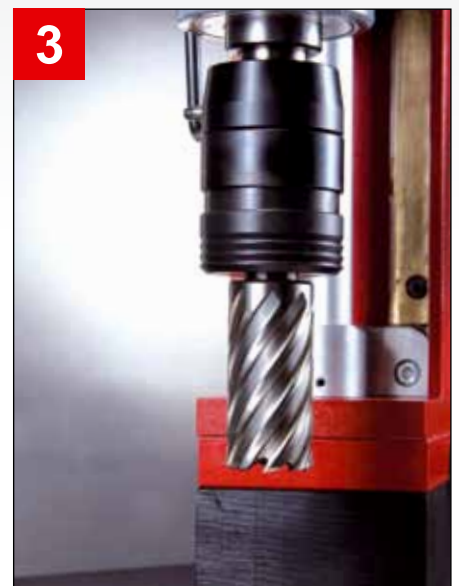
Bild 4: Um den Kernbohrer zu lösen, schieben Sie den Arretierungsring nach oben.
