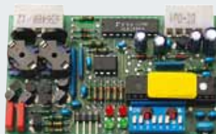
Inductielus-analysetoestel Insteekprintplaat, met één of twee kanalen; geschikt voor twee gescheiden inductielussen, levering zonder luskabel
