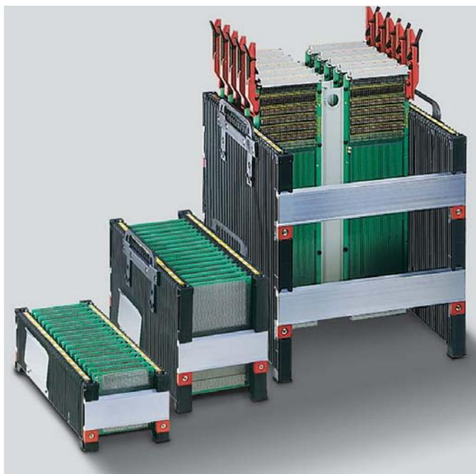
Les magasins pour circuits imprimés peuvent non seulement être chargés verticalement mais également horizontalement. Le système est complètement variable en largeur et peut être adapté en largeur à toute les tailles de circuits imprimés. Pour les différents circuits imprimés, des magasins de 100, 180 et 300 mm de haut sont disponibles.
