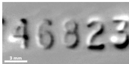
Abgeschliffene Seriennummer einer Waffe (forensische Untersuchungen)
