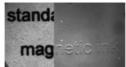
Gedruckte magnetische Tinte (links: optisch, rechts: magnetooptisch)
