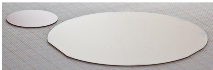
Magnetooptische Schicht auf einem 1 Zoll und 3 Zoll Substrat
