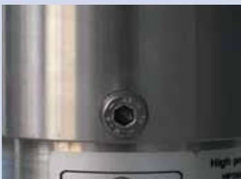
**Zusätzliche Absicherung gegen Lockerung der Gehäuse-Schraubverbindung durch pulsierenden Volumenstrom**
