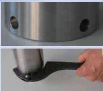
**Einfacher Elementwechsel mit Hakenschlüssel**
