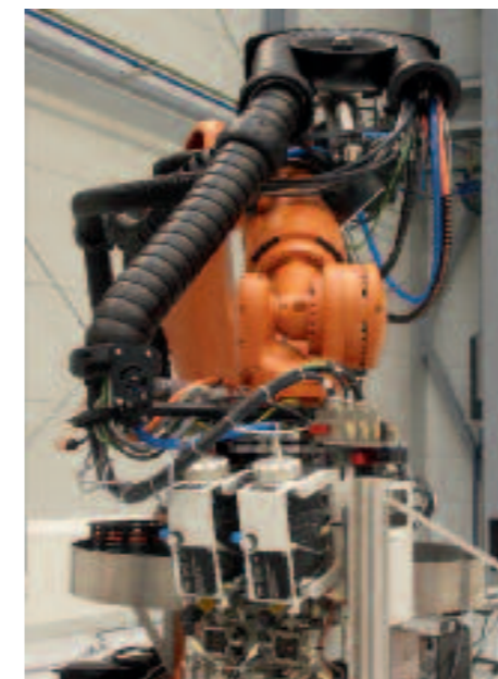
igus® chainflex®-Leitungen im Einsatz in mehrdimensional beweglicher Energieführung triflex® R für 6-Achs-Roboter.
