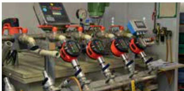
Chaque compteurs de débit est contrôlé et étalonné – un contrôle qualité intégral !
