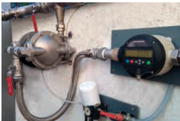
FMC 100 en combinaison avec une pompe pneumatique à membrane (ici : d'un autre fabricant) pour une utilisation manuelle.
