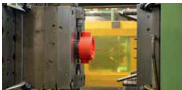
Propre production de moulage par injection – ici pour le corps d'un compteurs de débit FMC.
