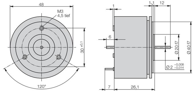
Fig. 6. KINAX 3W2 avec axe de commande 2 mm Ø de face, longueur 12 mm, 2 mm Ø de dos, longueur 6 mm.
