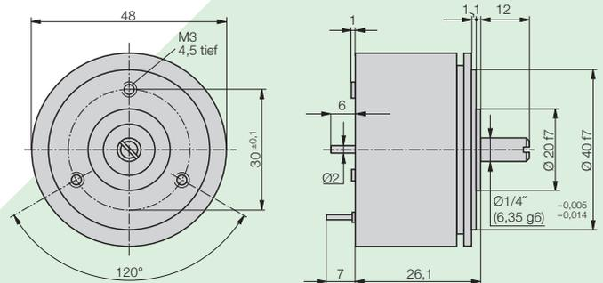
Fig. 10. KINAX 3W2 avec axe de commande 1/4" Ø, longueur 12 mm, 2 mm Ø de dos, longueur 6 mm
