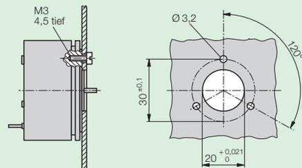
Fig. 12. Plan de perçage pour fixation par 3 vis à tête cylindrique M3.
