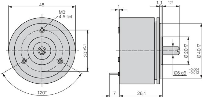
Fig. 7. KINAX 3W2 avec axe de commande 6 mm Ø, longueur 12 mm.
