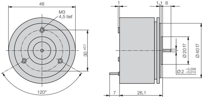
Fig. 5. KINAX 3W2 avec axe de commande 2 mm Ø, longueur 6 mm, exécution standard.
