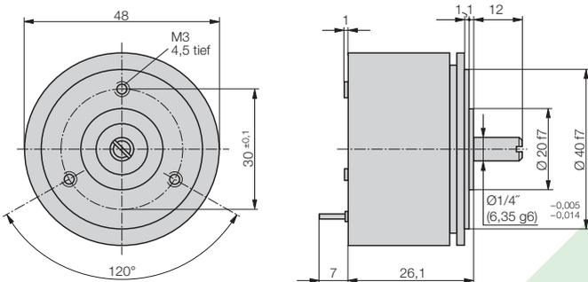
Fig. 9. KINAX 3W2 avec axe de commande 1/4" Ø, longueur 12 mm.
