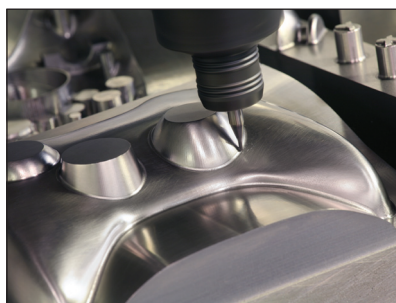
Die Inline-Spindel mit Direktantrieb und 12000 U/min von Haas in Kombination mit der Haas Hochgeschwindigkeitssteuerung mit "Look Ahead"-Funktion gewährleistet Genauigkeiten und Oberflächenqualitäten, wie sie von Formenbauern und anderen Hochpräzisionsindustrien verlangt werden.
