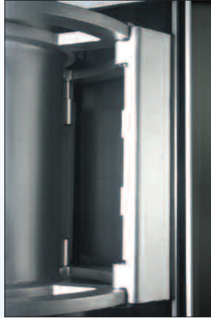
Rotor avec des racleurs pendulaires en métal.
