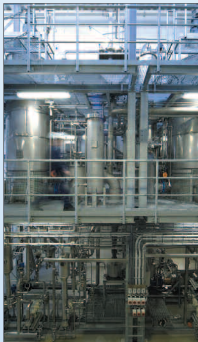
Unité de concentration d'acides gras Omega 3 dans des évaporateurs court trajet.
