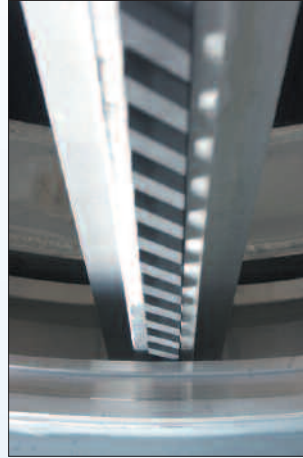
Rotor avec des éléments racleurs en PTFE ou en graphite.
