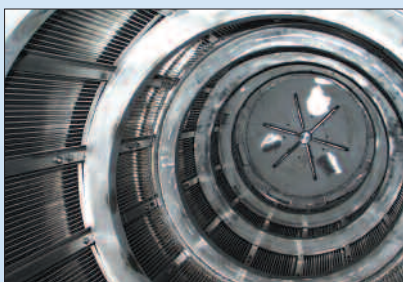
Coupe transversale d'un évaporateur à court trajet.
