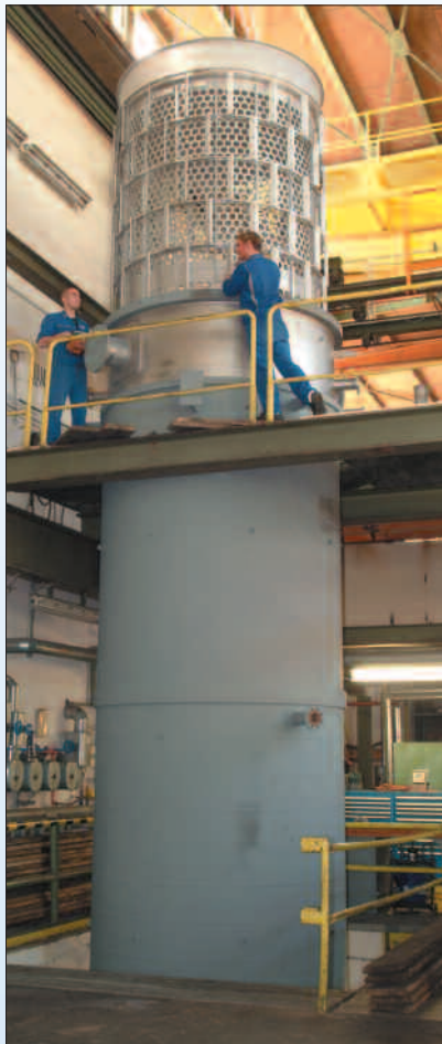
Evaporateur à couche mince sur sa plateforme d'essai Installation pilote pour l'évaporation d'esters méthyliques.
