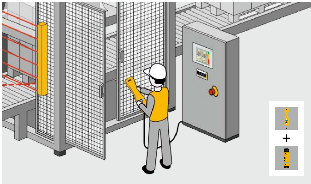
Die optimale Lösung: Zweihandüberwachung mit dem handbetätigten Befehlsgeber PITjog und dem Sicherheitsrelais PNOZ s6.
