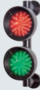
Signalleuchte Ø 150 mm Rot, Grün, in Kunststoffgehäuse mit Montagefuß, IP 65
