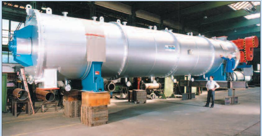
Sécheur à couche mince horizontal pour le séchage des boues.
