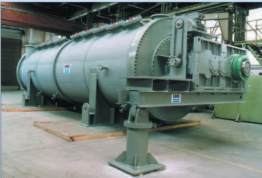
ROVACTOR® géant pour le séchage de polymères contenant des restes de solvants.
