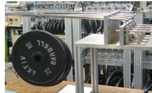
Die Entwicklung und Auslegung trocken laufender xiros®-Polymerkugellager beruht auf Tests des igus®-Polymerlagerlabors.
