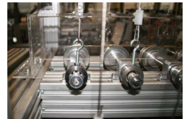
Kugellagertest im igus®-Polymerlabor
