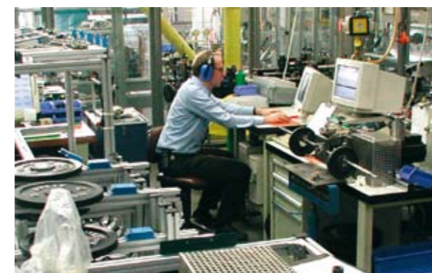
Die Materialkombinationen für Lagerringe, Kugeln und Käfige werden im igus®-Versuchslabor durch verschiedenste Belastungs- und Geschwindigkeitstests erprobt. So wird die anwendungsspezifische Auswahl des geeigneten Lagers und eine Lebensdauerabschätzung ermöglicht.
