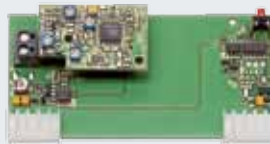
Receptor HER 1 (1 canal) Con salida de relé libre de potencial, sin cable de conexión o como pletina encastrable en el cuadro de maniobra
