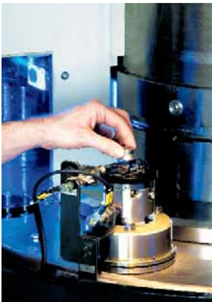
Handbeladung mit Sicherheitslichtvorhang und automatischer Abschaltung
