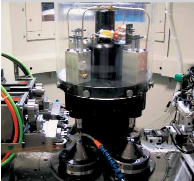
Bearbeitung von Ventildadeln mit Diamant-Bandwerkzeugen
