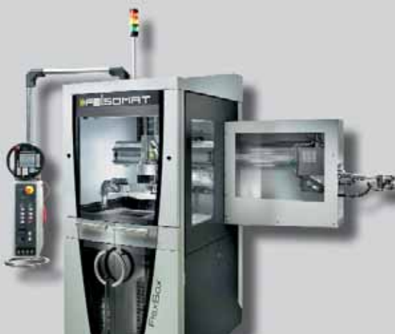
Handlingzelle mit Vormesseinrichtung (Bohrungstiefe) sowie Werkstücklageerkennung über Kamera zur Anbindung an MicroStar
