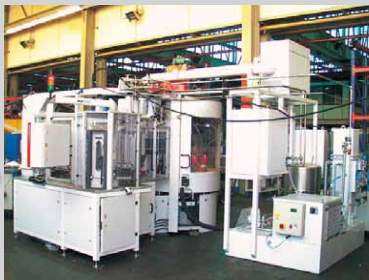
MicroStar mit Automationszelle aus Schüttgut in Stapelpalette mit Preprozess- und Inprozess-Messsteuerung sowie SPC-Teileschleuse
