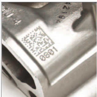
Lesen und Verifizieren von markierten Data Matrix Symbolen Reading small, hard-to-read Data Matrix codes
