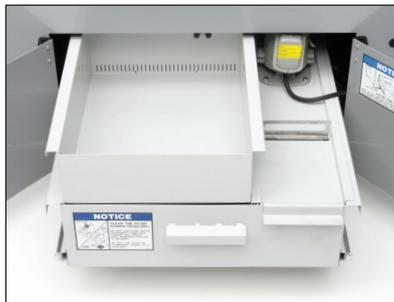
L'OM-2A offre également un réservoir d'arrosage coulissant avec pompe intégrée à la base de la machine.
