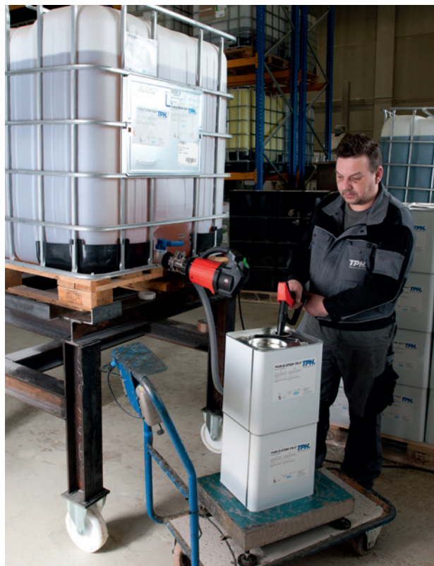
Zügiges Abfüllen über den Auslauf am IBC in einen Kanister.
