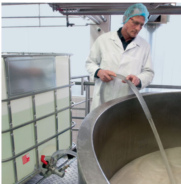
Fördern eines Mediums über den Auslauf am IBC, nach oben in ein Mischbehältnis.
