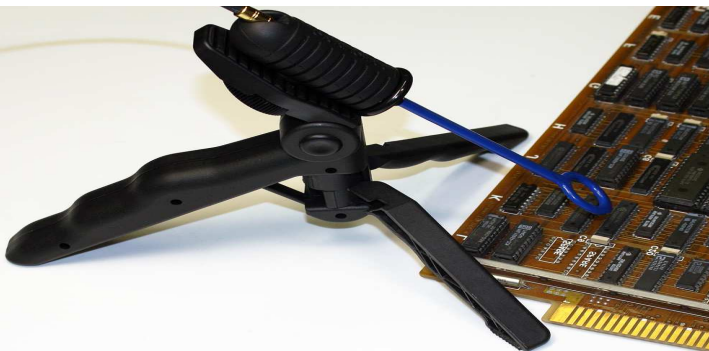
Sonde CEM, fixée sur le mini trépied inclus
