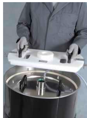
Montage du traverse de recentrage de la pompe.*
