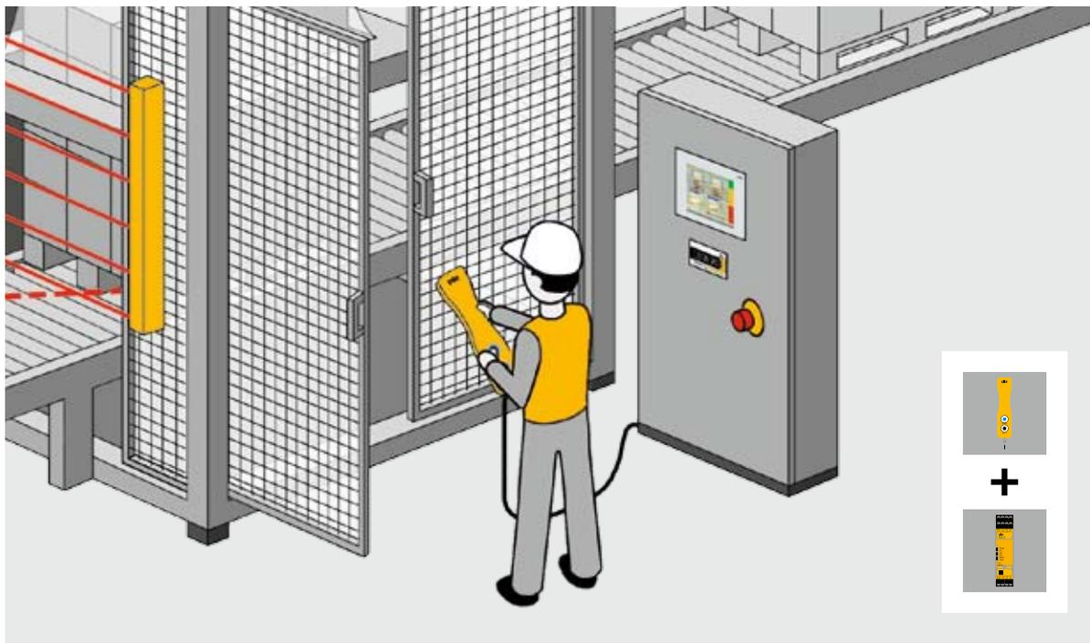
最佳解決方案：使用手動操作控制裝置 PITjog 與安全繼電器 PNOZ s6 執行雙手監控。
