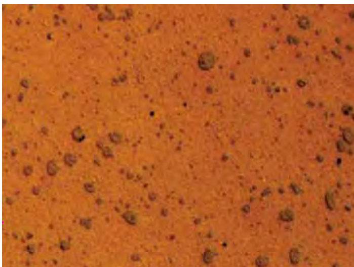
Bild 1.6: Basispolymere ohne Verstärkungsstoffe mit Festschmierstoffen, 50fach vergrößert, eingefärbt
