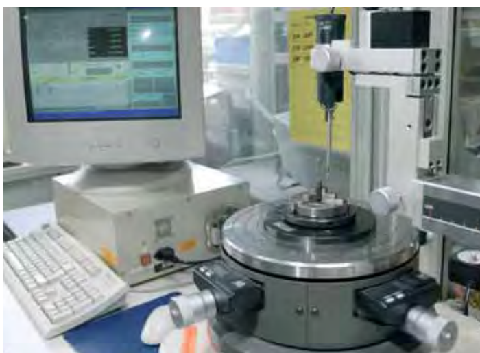
Bild 1.19: Messung des Innendurchmessers eines eingepressten Gleitlagers
