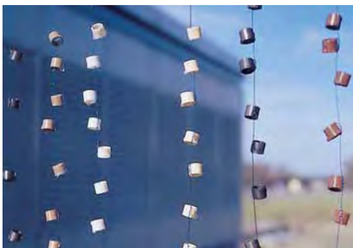
Bild 1.18: iglidur®-Gleitlager im UV-Langzeittest
