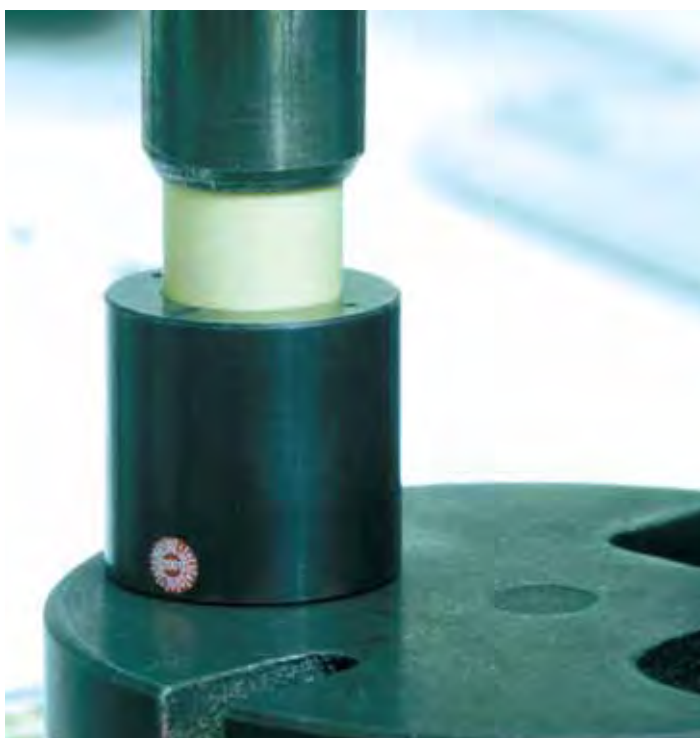
Bild 1.20: Die Montage erfolgt mit einem ebenen Stempel.
