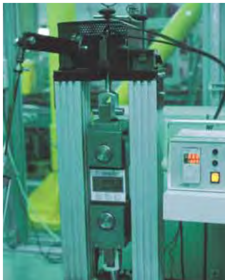
Bild 1.13: Prüfstand für höchste Belastungen bis 150 MPa und Temperaturen bis 250°C, schwenkend
