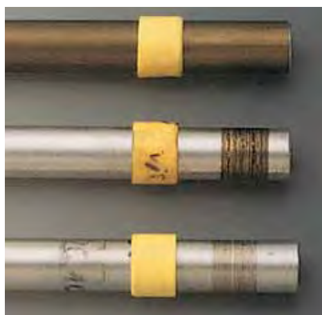
Bild 1.16: Verschleißuntersuchungen mit Aluminiumwellen
