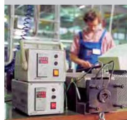
Bild 1.14: Verschleißprüfstand für Versuche bei hohen Temperaturen
