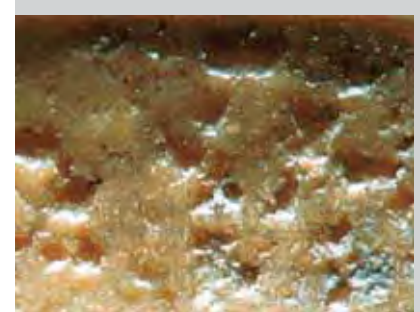
Bild 1.12: Erosionsschäden durch zu glatte Wellen
