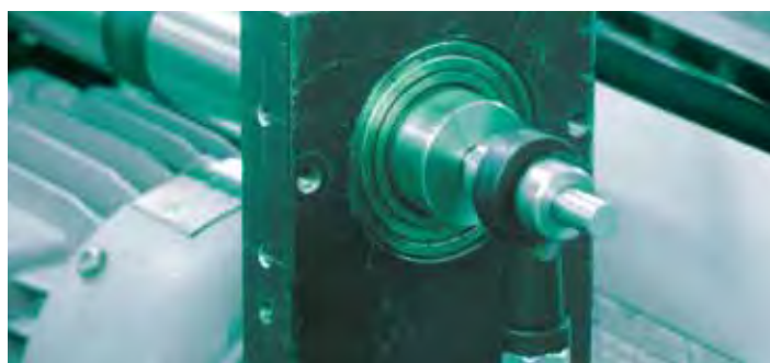
Bild 1.8: Ermittlung der maximalen Gleitgeschwindigkeiten eines igubal®-Gelenkkopfs bei hohen Rotationsgeschwindigkeiten
