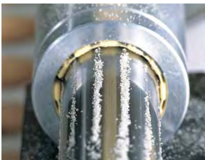
Bild 1.15: Hohe Verschleißfestigkeit: Gleitlager im permanenten Kontakt mit Sand
