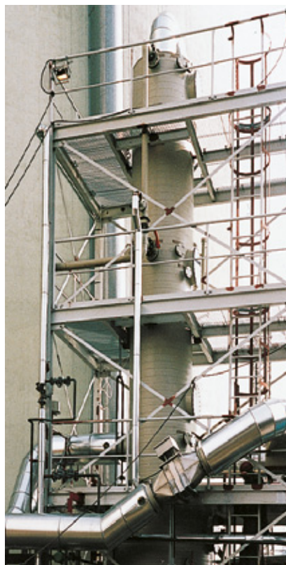
Füllkörperwäscher zur \text{SO}_2 -Abscheidung für 6.000 \text{ Nm}^3/\text{h}
