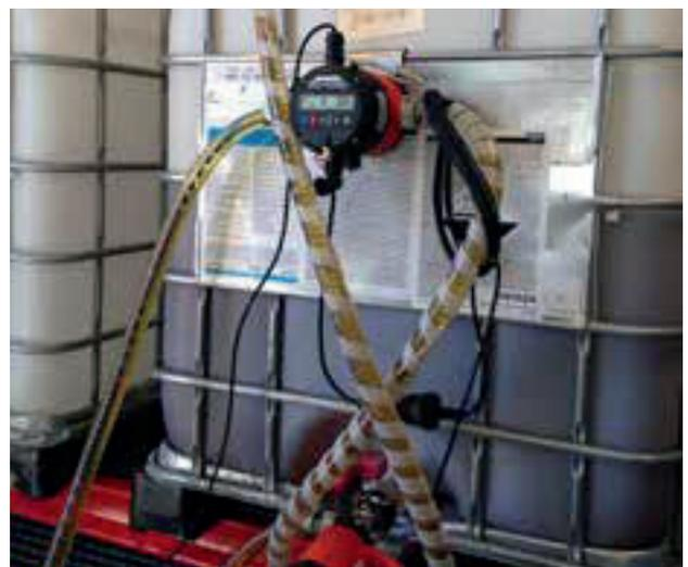
Halbautomatische Abfüllung mit FMC 100 und Schaltverstärker FSV 100 aus einem IBC.
