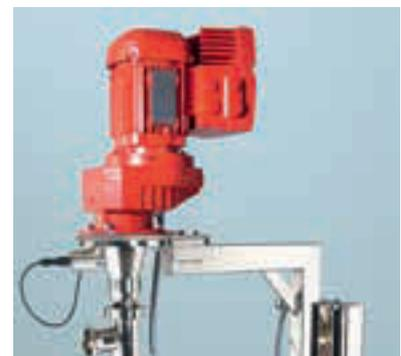
Mit dem Lagerflansch mit Impulsgeber ist eine berührungslose Durchflussmessung möglich.
