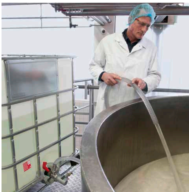
Transfert d'un fluide via l'écoulement sur l'IBC, vers le haut dans un mélangeur (moteur pneumatique).
