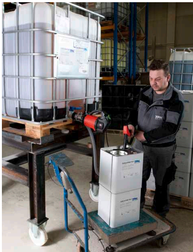
Remplissage rapide dans un bidon via l'écoulement sur l'IBC (moteur électrique).
