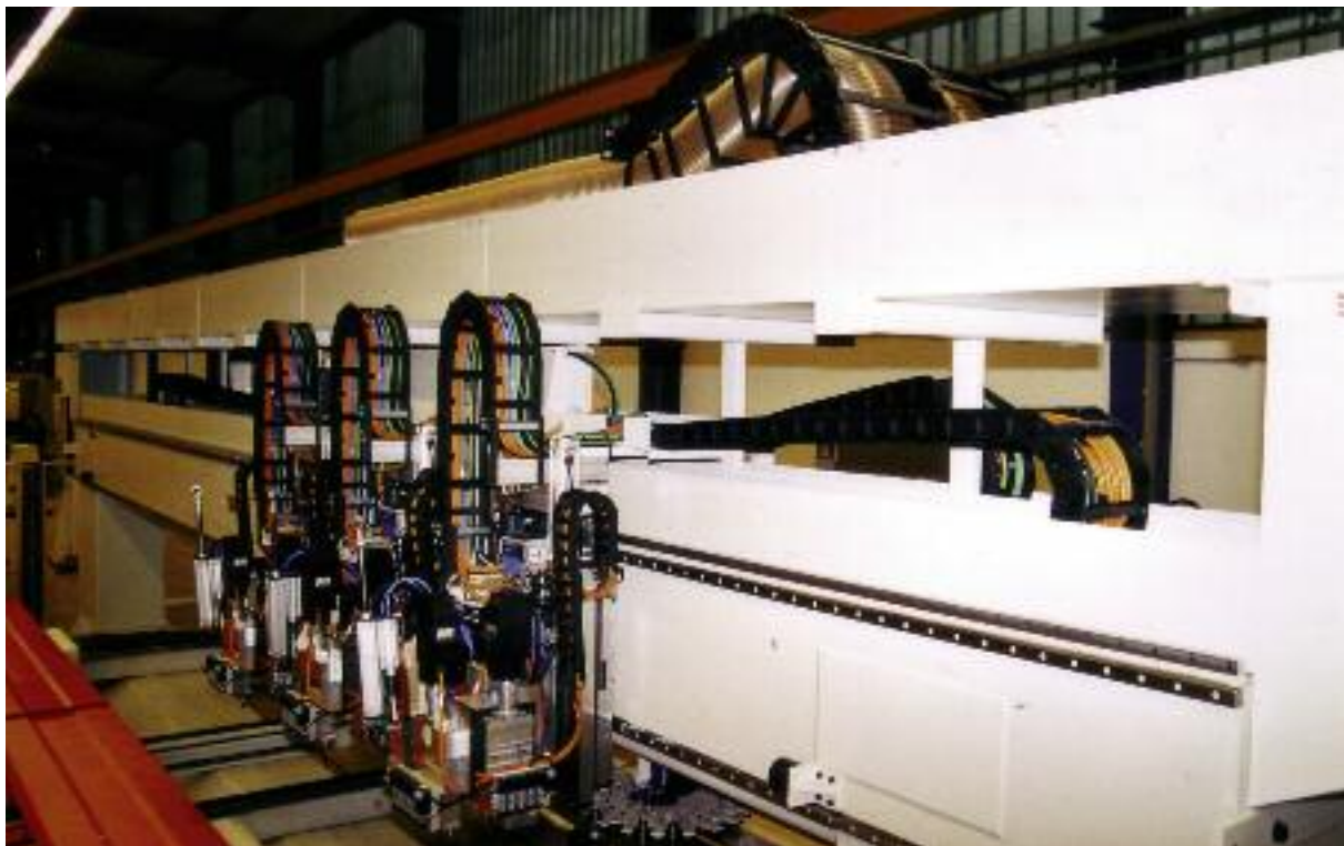
Holzbearbeitungsmaschinen mit E-Ketten® und Chainflex®-Leitungen
